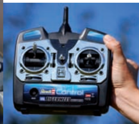
Der Revell Control-Sender mit 2,4-Gigahertz-Technik. Serienmäßig wird das optisch ansprechend gestylte Gerät mit Drossel links ausgeliefert. Mit den Dip-Schaltern unten rechts lassen sich alle Funktionen umkehren
