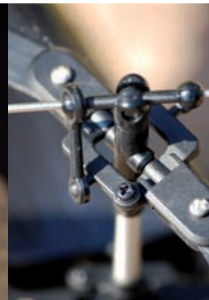
Klassisch: Der obere Rotor ist über ein Gestänge mit der Stabilisierungseinheit verbunden – das Geheimnis für die enormen Flugstabilität und gute Manövrierbarkeit. Outdoor ist dieses Rotorsystem generell nur bis zu leichtem Wind einsetzbar
